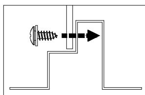
Postavte plechy na podlahovou konstrukci, aby se díry na jednotlivých dílech plechů překrývaly a pomocí šroubků je zvenku sešroubujte. Zkontrolujte, jestli umístění a překrytí dílů odpovídá popisu na obrázku. Rohové díly musí být v pravém úhlu, aby došlo k překrytí spojovacích dříků na dalších částech podlahové konstrukce.
