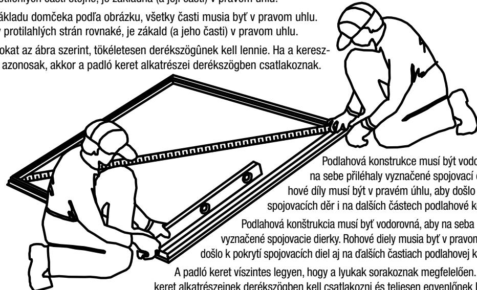
Podlahová konstrukce musí být vodorovná, aby na sebe přiléhaly vyznačené spojovací dírky. Rohové díly musí být v pravém úhlu, aby došlo k překrytí spojovacích dír i v dalších částech podlahové konstrukce.
