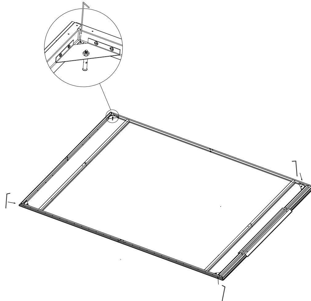
Venujte pozornosť ukotvení domku. Stenové panely je potreba podeprieť. Venujte pozornosť ukotveniu domčeku, stenové panely je potrebné podpierať. Szenteljen figyelmet a ház rögzítésének. A falakat meg kell támasztani.
